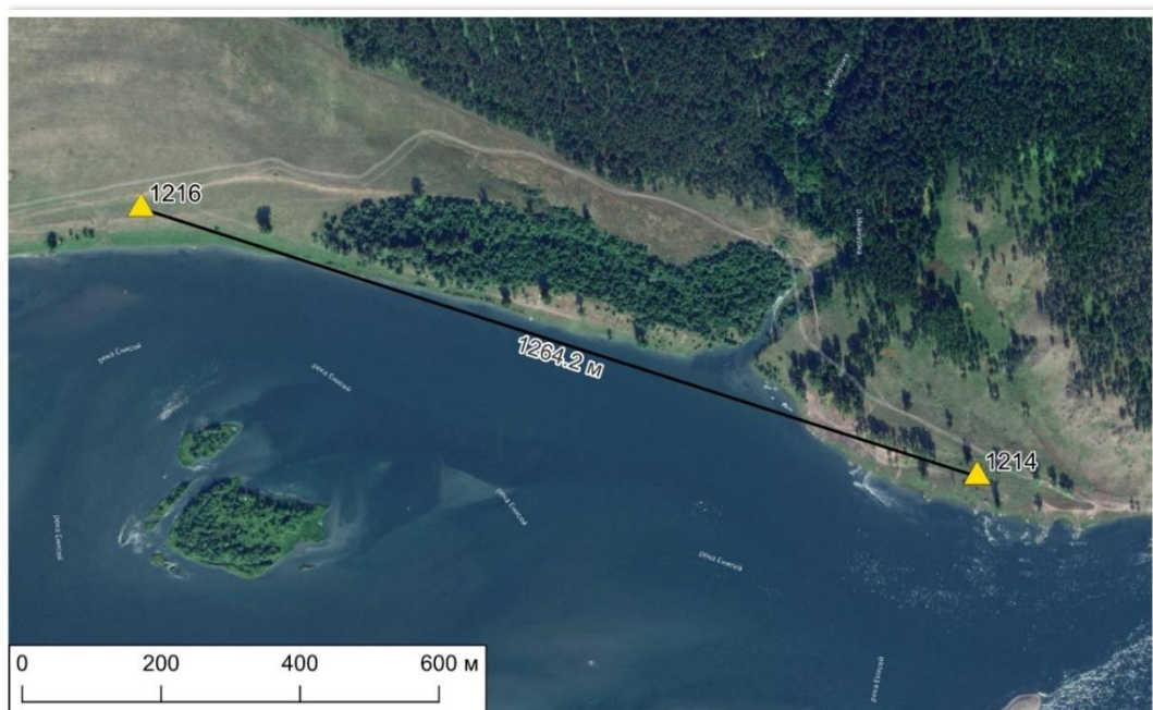
Рисунок 6.2 – Схема измерений базовой линии эксперимента на берегу р. Енисей
