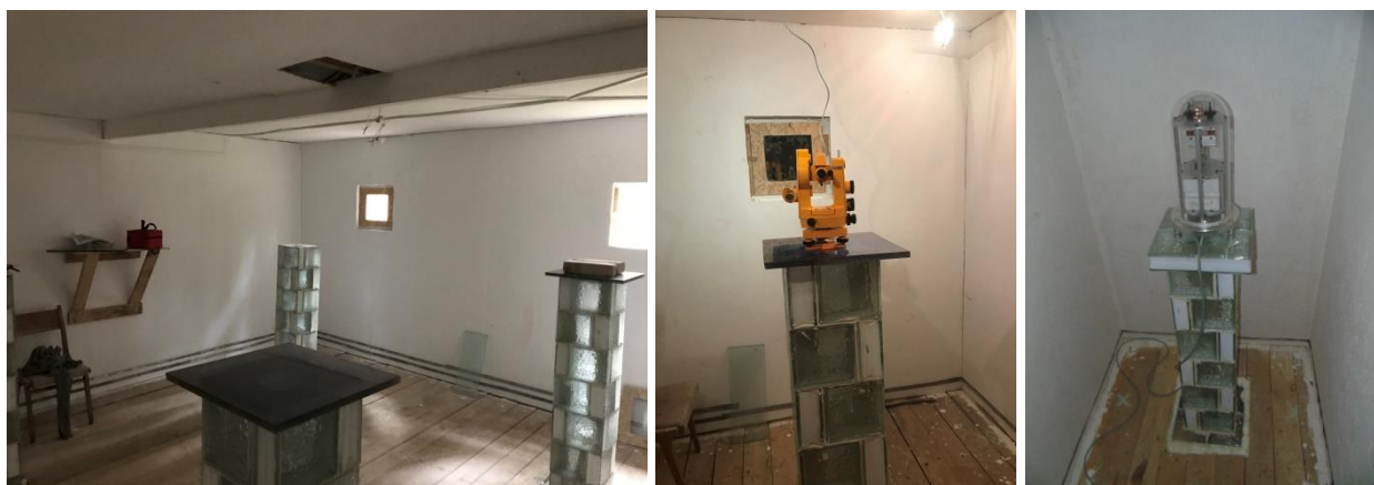
Рисунок 5.2 – Магнитная обсерватория «Михнево»: интерьер абсолютного павильона (слева), феррозондовый деклинометр/инклинометр MinGeo на немагнитном теодолите THEO 010 (в середине) и трехкомпонентный векторный магнитометр DTU Space FGE (справа)
