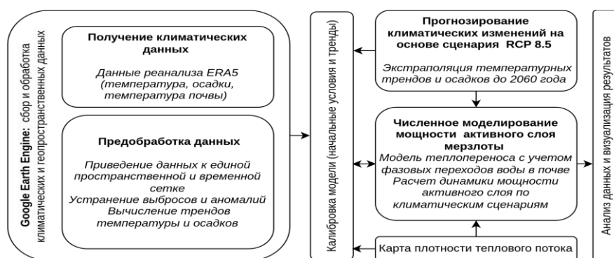
Рисунок 7.2 – Блок-схема численного моделирования динамики активного слоя вечной мерзлоты
