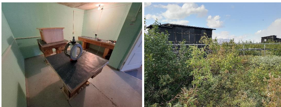
Рисунок 7.1 – Магнитная обсерватория «Норильск»: установленный магнитометр ПОС-4 (а) и внешний вид павильонов со специальной морозо- и ветростойкой облицовкой (б)
